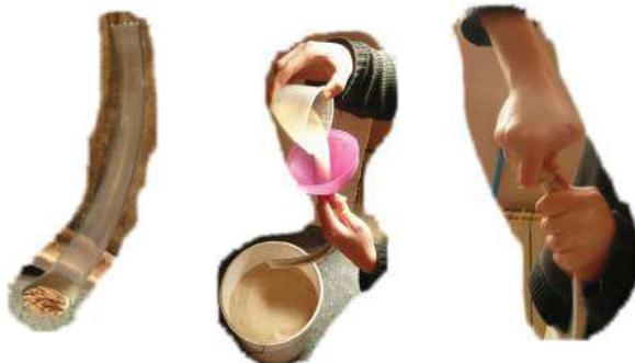
4. Remplissez le tube souple de sable à l'aide de l'entonnoir. Fermez les 2 extrémités avec les 2 bouchons en liège.
